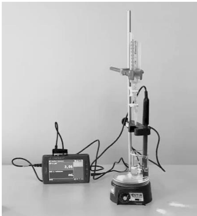
Figura 2: Equipo de Valoración Ácido-Base Automatizado desarrollado por la UNED.
